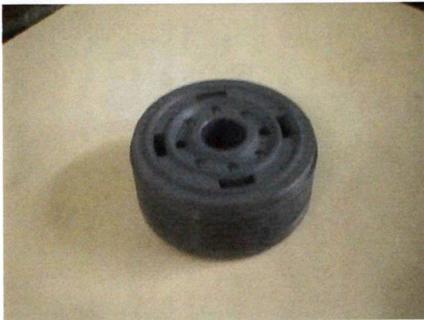
Peça com tratamento de Ferrox (pistão de amortecedor)
